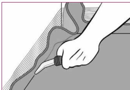
Utilice el Tarkett Hockey Stick o Tarkett Corner Roller para presionar el material firmemente en la unión entre el piso y la pared. En áreas donde el rollo es suficiente para cubrir toda el área, se puede aplicar el adhesivo sobre todo el suelo antes de instalar el revestimiento. Aunque esto requiere experiencia, es el método de instalación más rápido.
